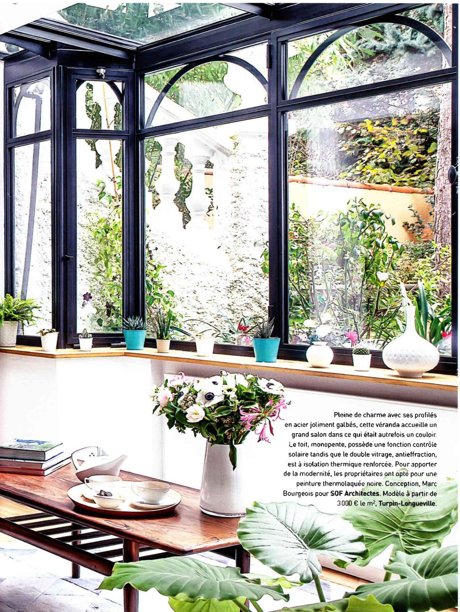
Pleine de charme avec ses profilés en acier joliment galbés, cette véranda accueille un grand salon dans ce qui était autrefois un couloir. Le toit, monopente, possède une fonction contrôle solaire tandis que le double vitrage, antieffraction, est à isolation thermique renforcée. Pour apporter de la modernité, les propriétaires ont opté pour une peinture thermolaquée noire. Conception, Marc Bourgeois pour **SOF Architectes**. Modèle à partir de 3000 € le m<sup>2</sup>, Turpin-Longueville.
